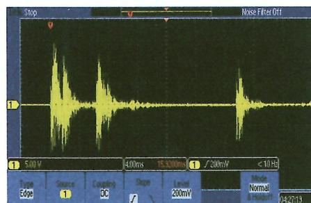
Dazu wird unter Anderem der ganze Stanzprozess mittels Körperschall analysiert und den einzelnen Bearbeitungsfolgen zugeordnet. Die Fertigteile inklusive der Fertigungsabfälle wurden systematisch mit einem hochauflösenden 3D Digital-Mikroskop auf die auftretenden Wirkmechanismen optisch und geometrisch analysiert. Mit dem Mikroskop können umfangreiche Analysen vorgenommen werden, damit die Zusammenhänge und Mechanismen im Detail besser verstanden werden.
